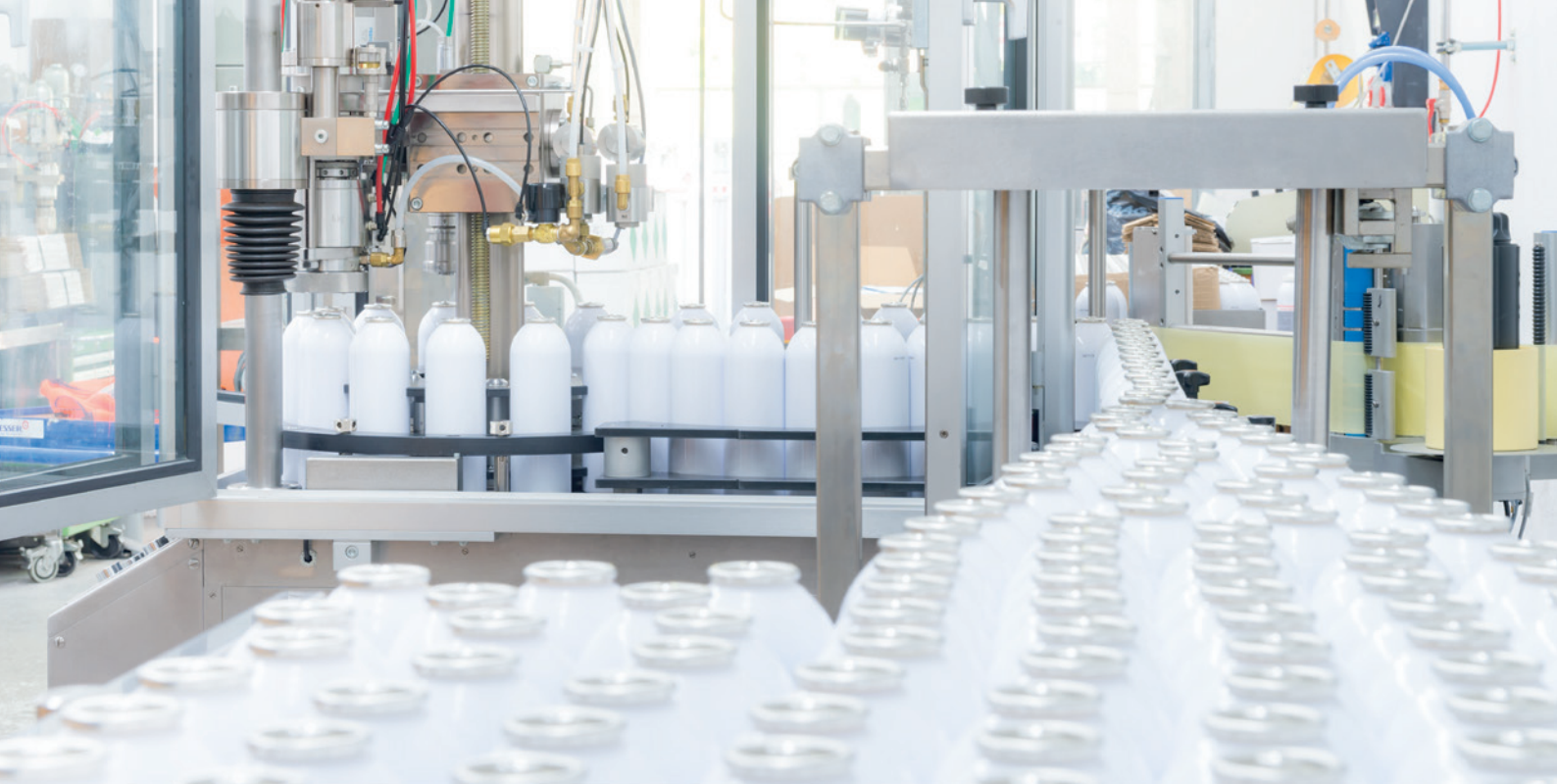
Llenado automático de cápsulas a presión
