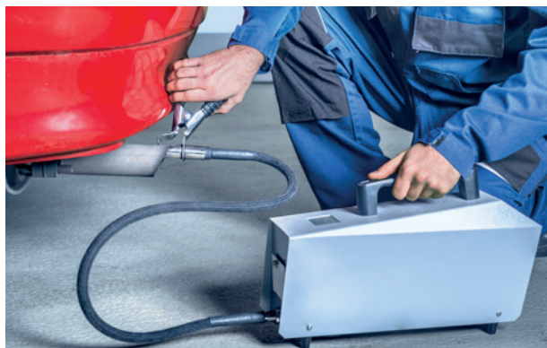
Test de emisión de gases de escape de vehículos
