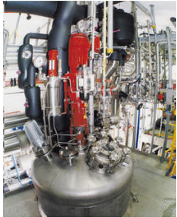
Reactor equipado para las altas y muy bajas temperaturas de síntesis
