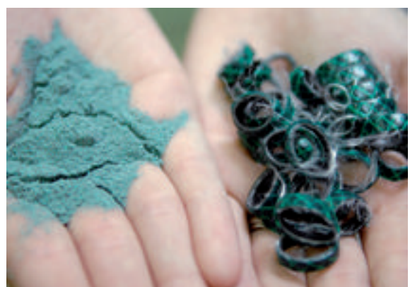
Piezas de manguera antes y después de la molienda criogénica
